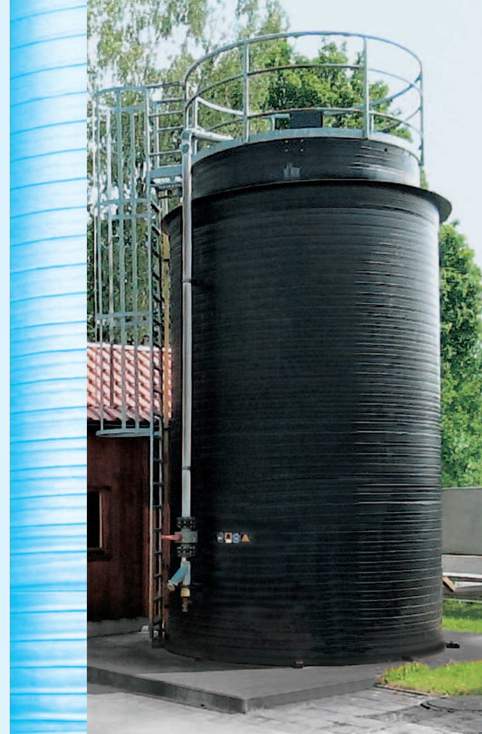
formoplast Lagerbehälter mit Auffangvorrichtungen aus PE-HD für Fällungsmittel auf Kläranlagen Nutzinhalt: 25.000 Liter, Durchmesser: 3.000 mm, Bauhöhe: 4.700 mm
