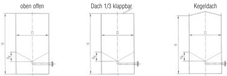
PP-Lagerbehälter mit Flachboden für Biodiesel Lagertemperatur: 50 C Inhalt: 113 m³ Durchmesser: 2.800 mm Höhe: 18.920 mm
